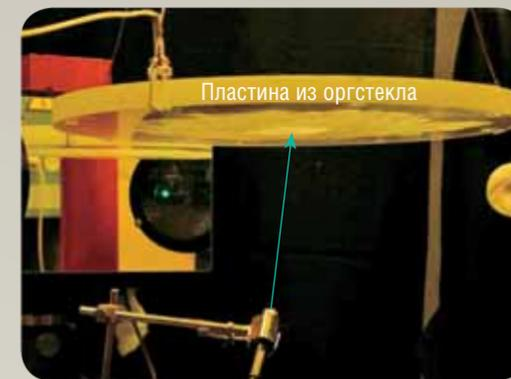
В центр пластины снизу направляется ИК-излучение, очень быстро нагревающее ее тонкий слой и приповерхностный воздух. Оргстекло испаряется, а быстро расширяющийся воздух порождает ударную волну, распространяющуюся от пластины
