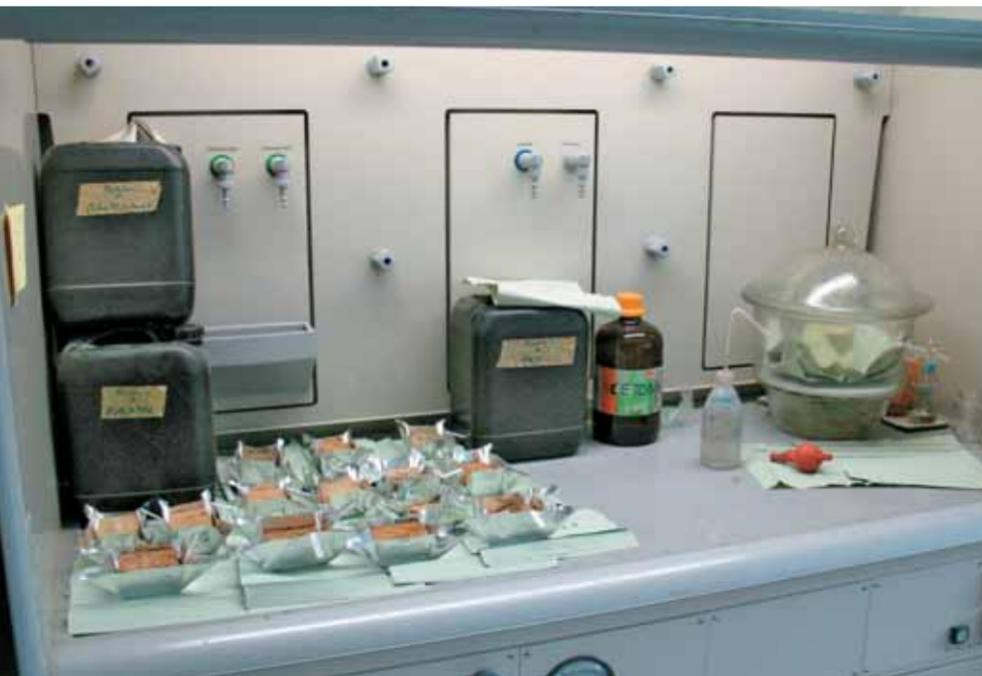
Изготовление почвенных шлифов проводится на специальном оборудовании в лаборатории микроморфологии почв Трирского университета (Германия). Справа – готовый шлиф, представляющий из себя тонкий срез почвы, приклеенный к стеклу
