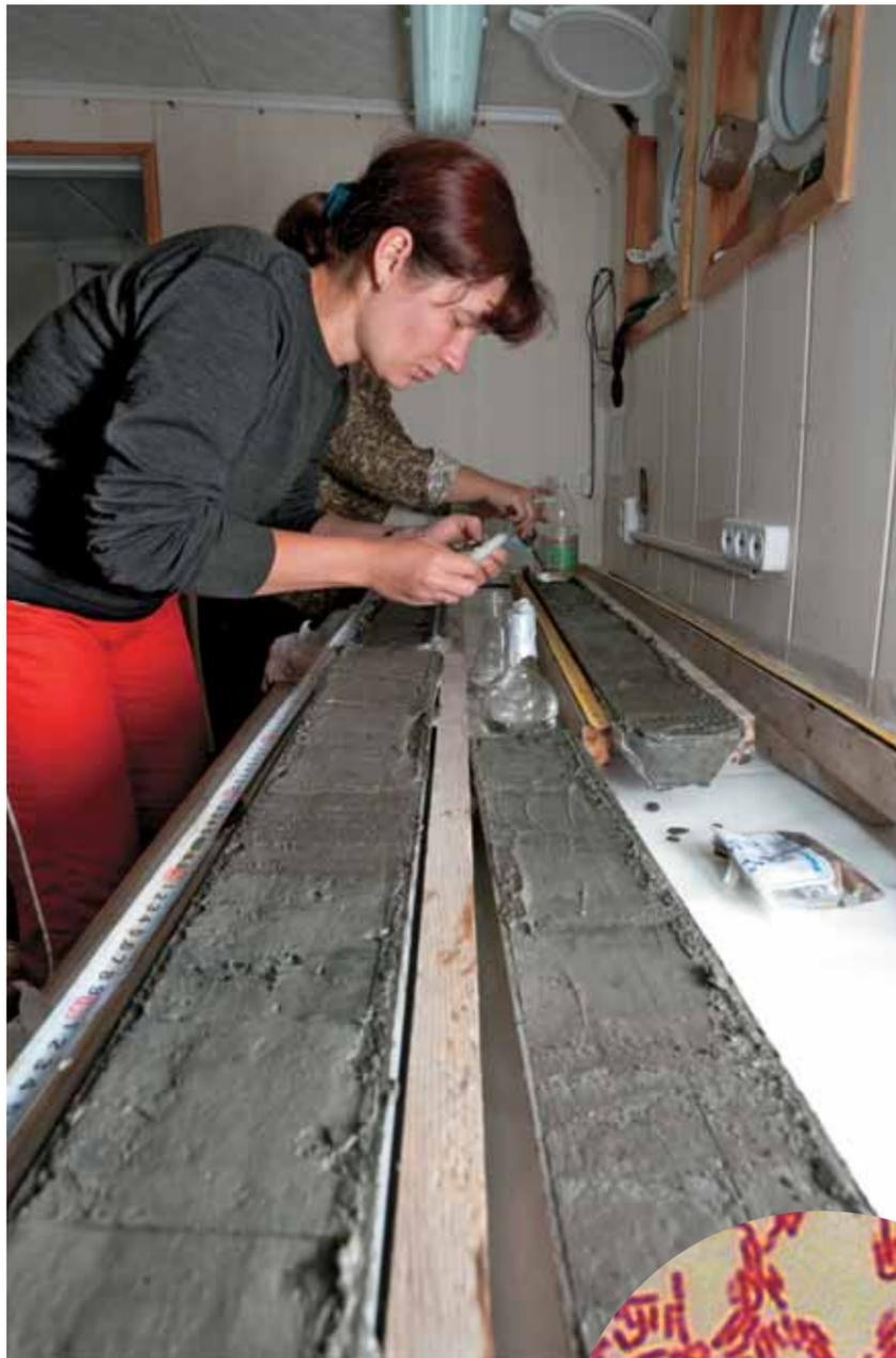
Это не просто грязь, а керны донных осадков Байкала, из которых отбирают пробы для химических и микробиологических анализов с учетом глубины залегания отложения.
