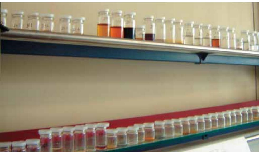
Работа химика-синтетика требует кропотливого поиска оптимальных условий синтеза, для чего приходится проводить сотни экспериментов по кристаллизации. Для соединений, которые не разрушаются на воздухе, кристаллизацию проводят в обычных банках (слева). Для получения веществ, которым требуется инертная атмосфера, используется вакуумная камера (внизу)
