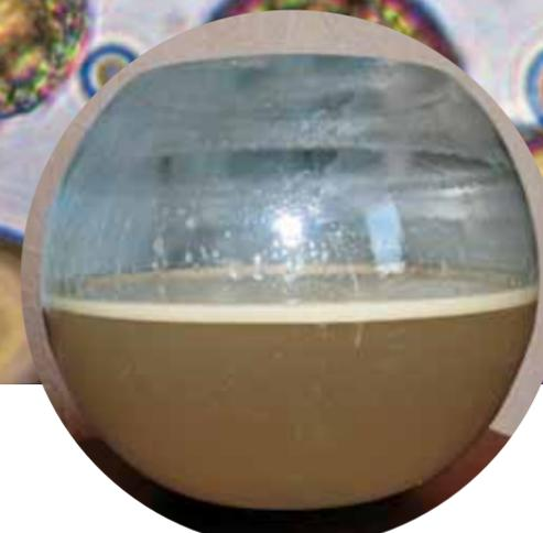
Вещества-сурфактанты, выделяемые углеводородокисляющими бактериями р. *Rhodococcus*, способствуют уменьшению поверхностного натяжения, что облегчает им проникновение внутрь углеводородных капель. Сами капли при этом дробятся, образуя мелкодисперсную эмульсию. Через четверо суток культивирования бактерий на среде с добавлением гексадекана их биомасса выросла до  $4,8 \cdot 10^8$  клеток/мл (вверху) Световая микроскопия
