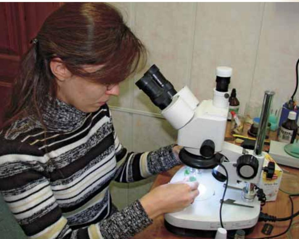
Первая задача – выбрать среди кристаллов один, наиболее подходящий для анализа. Затем его нужно закрепить, например, на нейлоновой нити (толщиной 20 мкм), которая соединяется через специальный держатель с винтом точной регулировки для микрометрового позиционирования
